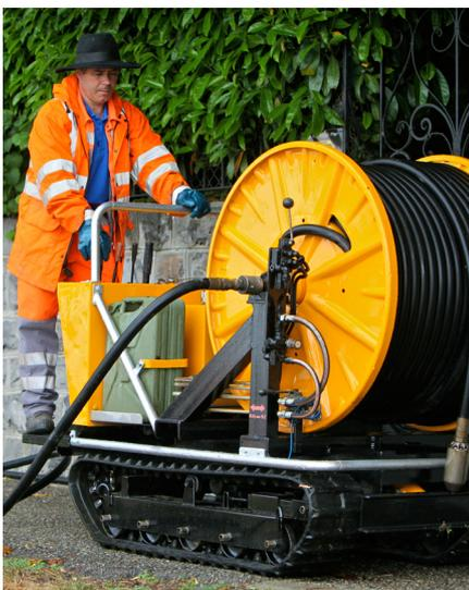
«Yaka» satellite équipé d'un tambour hydraulique.
